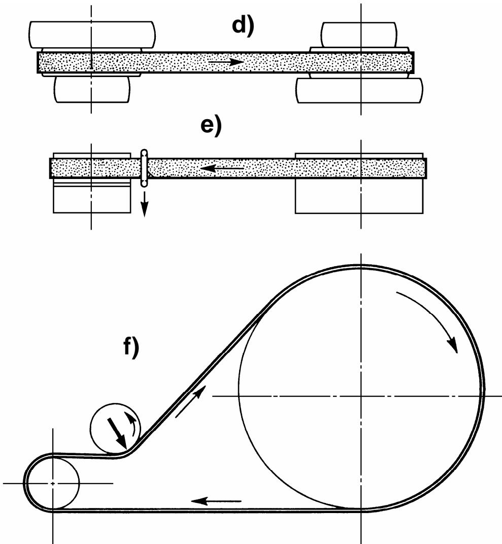
**Vrste remenskih prijenosa:** a) otvoreni remenski prijenos, b) križni prijenos, c) polukrižni prijenos, d) prijenos stupnjevanom remenicom, e) prijenos pogonskom i slobodnom remenicom, f) prijenos zateznom remenicom
